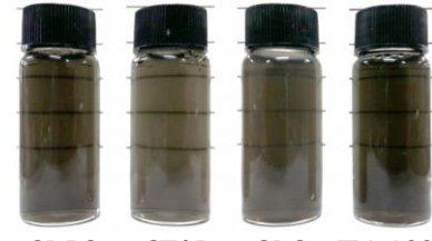
다양한 분산제가 첨가된 CNT 나노유체 (Water-based CNT 0.005vol%)
